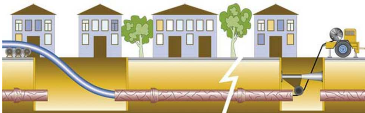
Рис. 1. Метод замены участка трубопровода «Труба в трубе»
