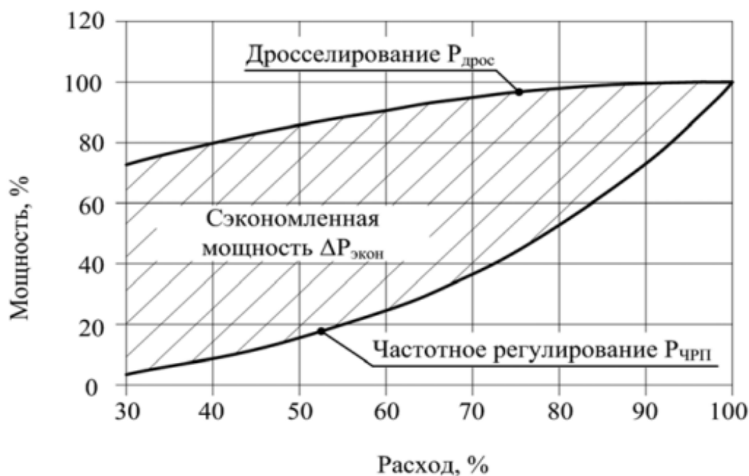
Рис. 4. График зависимости мощности насоса «Группы ГМС» от расхода
