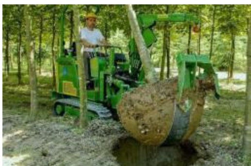
Рисунок 5- Механизм пересадки саженцев с поворотным вибрационным ножом
