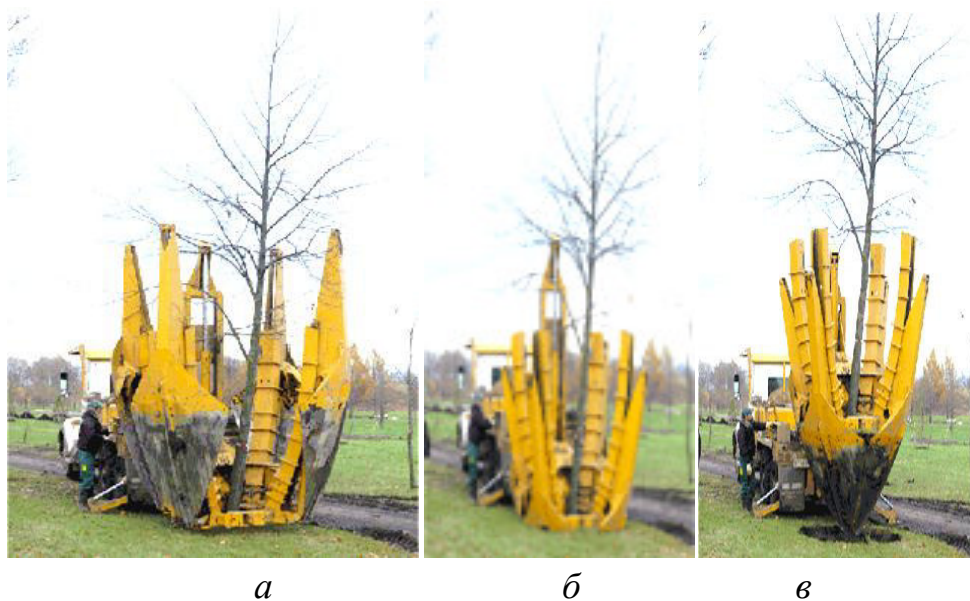
Рисунок 2 – Извлечение дерева из грунта для пересадки: а - установка ножей вокруг дерева; б - заглубление ножей; в - подъём дерева с корневой системой
