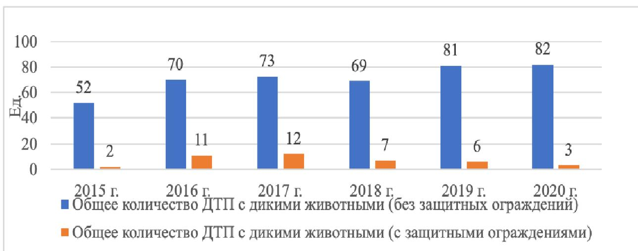
Рис. Статистика ДТП на автомобильной дороге М-1 «Беларусь» без защитных ограждений и на автомобильной дороге М-4 «Дон» с защитными ограждениями [6]
