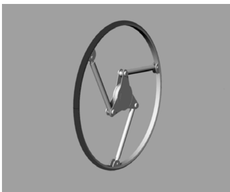
Рис. 3. Конструкция SOFTWHEEL колеса и амортизатора
