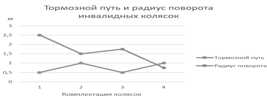
Рис. 6. Радиус поворота и тормозной путь инвалидных колясок различных комплектаций
