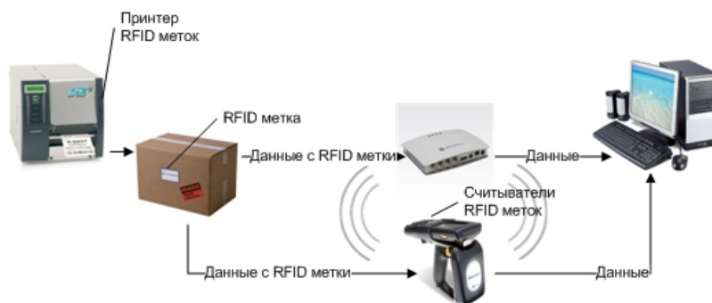
Рис. 1. Схема работы с помощью технологии RFID
