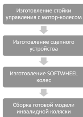
Рис. 1. Этапы производства инвалидной коляски с мотор-колесом
