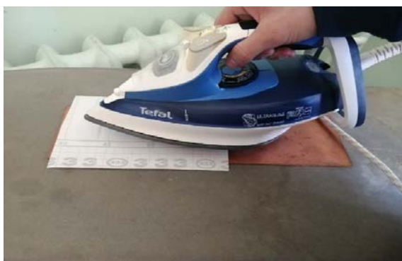
Рис. 3. Перенос рисунка на стеклотекстолит
